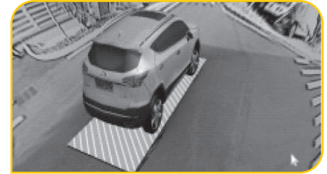
تصویر ۹، تصویر سه‌بعدی عقب راست و گردش به چپ است، دسته دنده در موقعیت دنده عقب قرار ندارد
